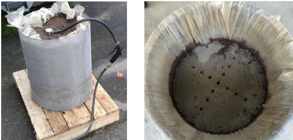
Abbildung 1: Links eine mittig in das Testsubstrat eingeführte Lanze mit Druckluftanschluss für erste Tastversuche. Rechts die Einstichschablone des Penetrometers in 5, 10 und 15 cm Abstand zu der Injektionsstelle
