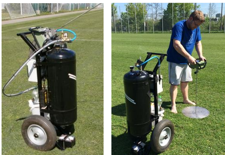
Abbildung 2: Links: Einzellanzen-Gerät des Instituts für Agrartechnik. Rechts: Messung des Eindringwiderstands durch Penetrometer und Einstichschablone nach erfolgter Lockerung
