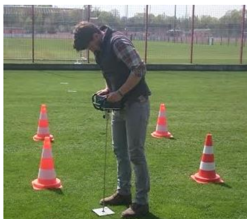
Abbildung 3: Links: Verteilung der 8 Versuchspartellen am Beispiel Mercedes Benz Arena, Stuttgart. Partellen 1-4 dienten der rein pneumatischen Lockerung, Partellen 5-8 der kombinierten Lockerung. Rechts: Messung des Eindringwiderstands
