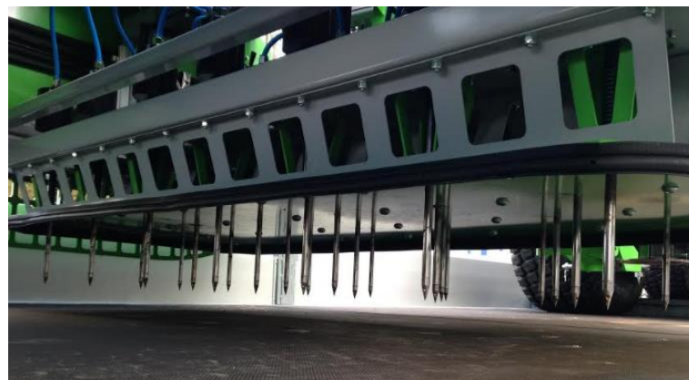
Abbildung 8: Lanzentisch mit insgesamt 26 Injektionslanzen bei 170 cm Arbeitsbreite sowohl bei airtter® Duplex, als auch bei airtter® Kompakt.
